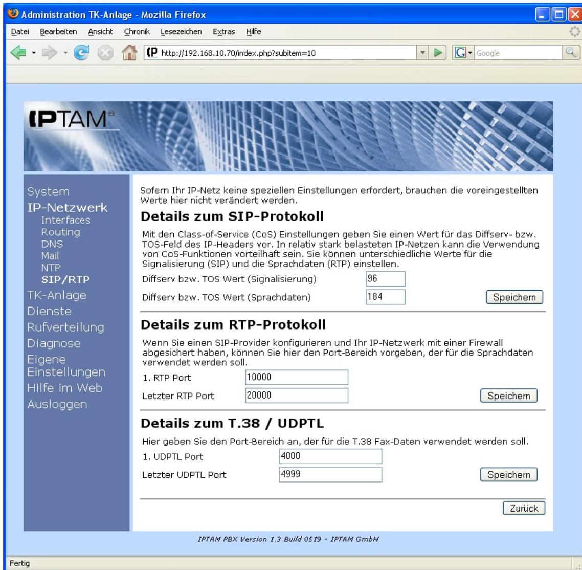
Abbildung 13.3: Einstellung des UDPTL Portbereichs für T.38 Pass Through
