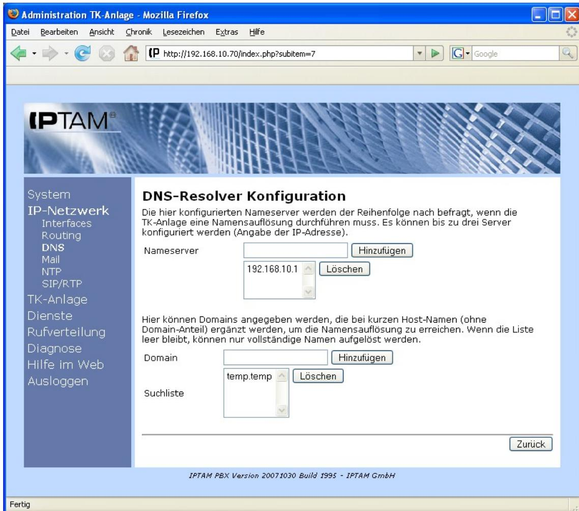
Abbildung 10.14.: Angabe eines DNS-Resolvers
