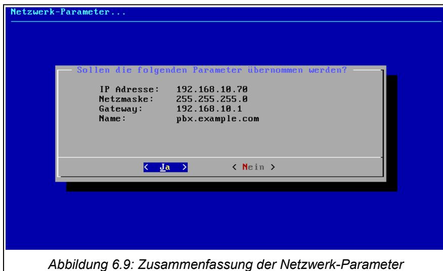
Abbildung 6.9: Zusammenfassung der Netzwerk-Parameter
