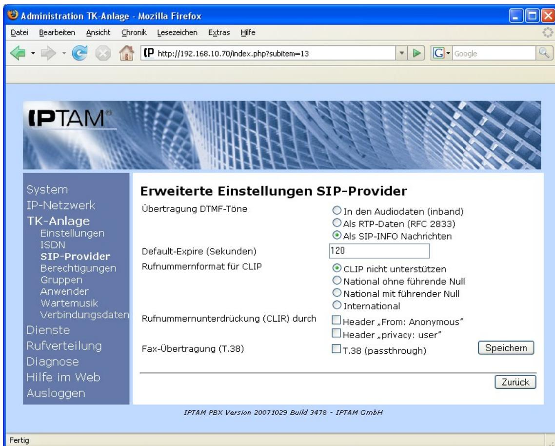
Abbildung 7.8.: Erweiterte Einstellungen zum SIP Provider
