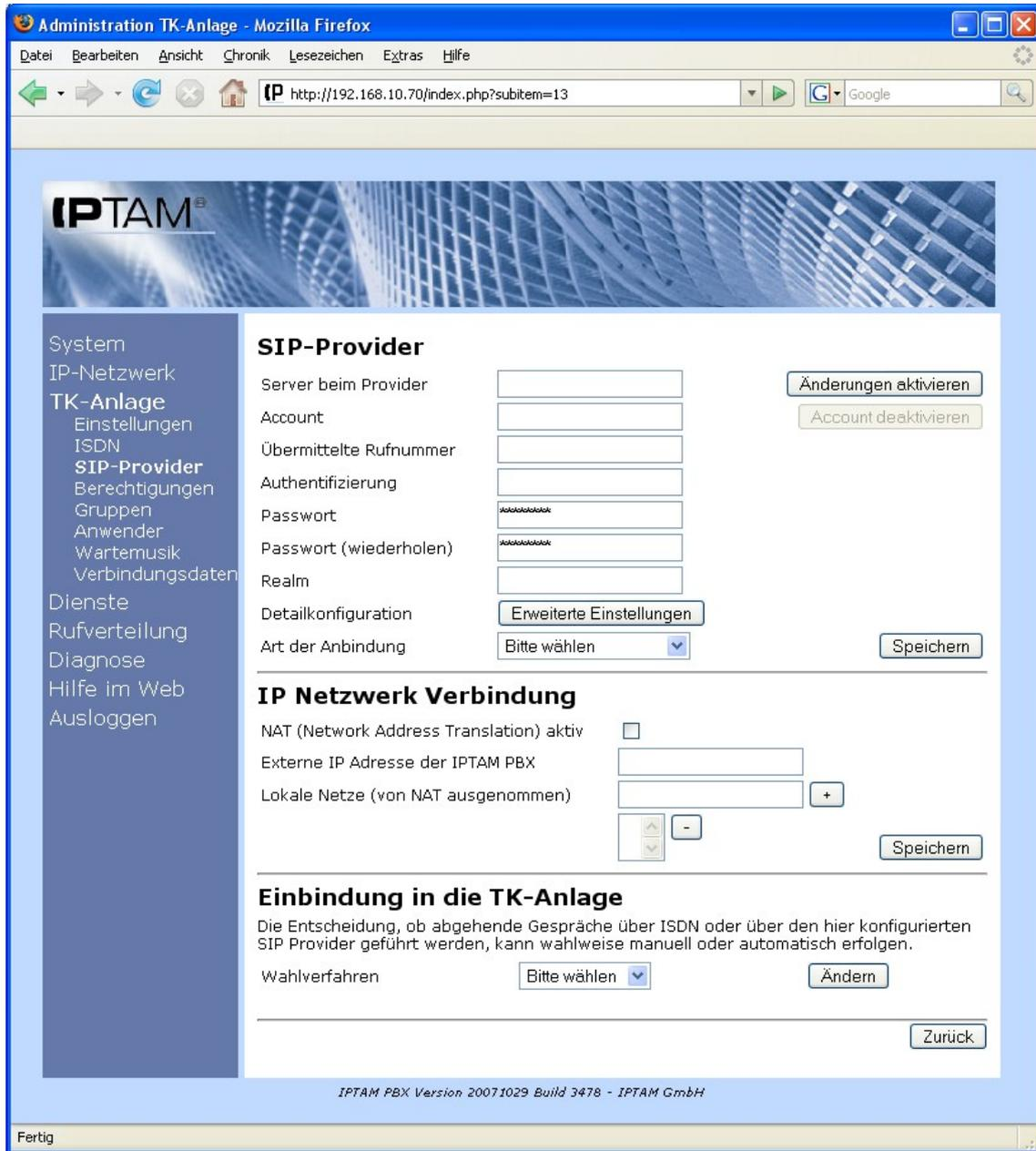
Abbildung 7.7.: Einstellung des SIP-Providers
